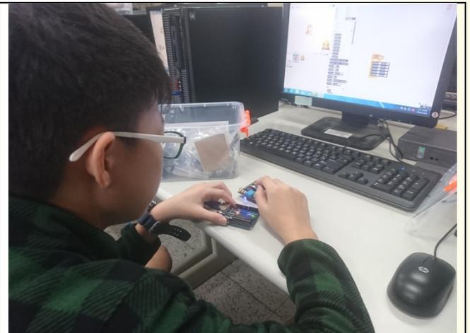
以 S4A 搭配 Arduino 實作 LED 控制專題，同學可以直接觀看 LED 燈號是否照程式的設定而運作
