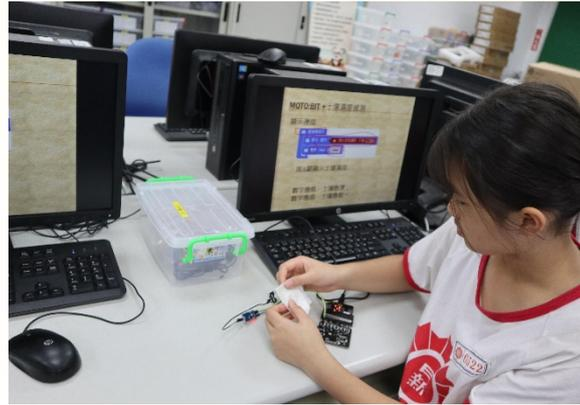
使用 micro:bit 板子，寫程式偵測溼度
