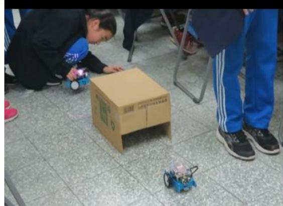
**火車過山洞**：透過活動設計，讓學生從過山洞的明暗差異，透過光線感測器數值變化引發鳴峰器聲響效果。
