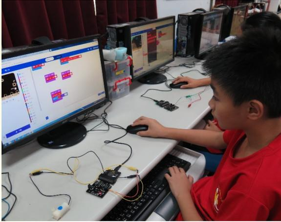
使用 micro:bit 板子，寫程式控制抽水馬達
